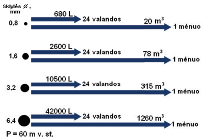
2 pav. Vandens nuostoliai per skylės vamzdžiuose.
